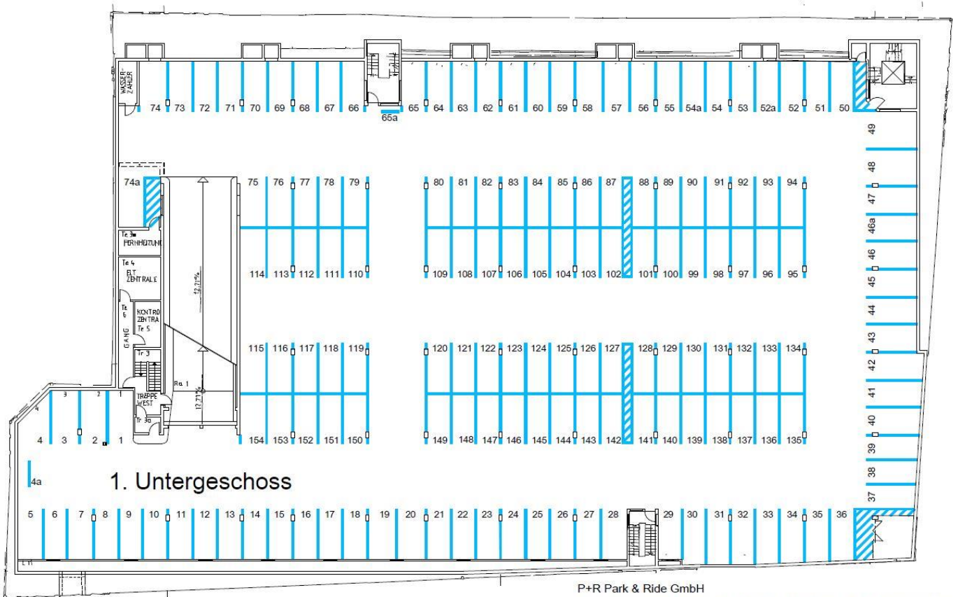
P+R Park & Ride GmbH Anwohnergarage Kellerstraße, Stellplatzmarkierung und -Nummerierung 1. Untergeschoss, o. Maßstab / 23.03.2017 / Weigl
